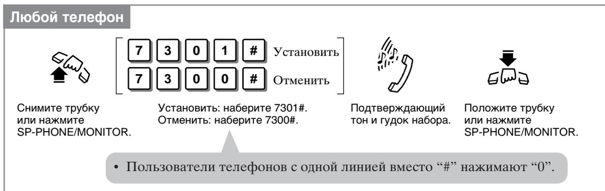
Снимите трубку или нажмите SP-PHONE/MONITOR.
