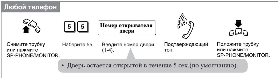
Снимите трубку или нажмите SP-PHONE/MONITOR.
