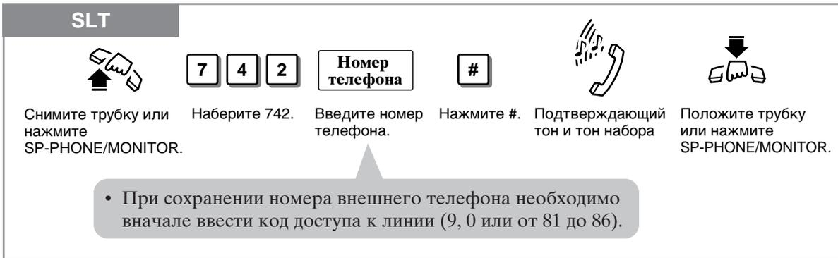
Снимите трубку или нажмите SP-PHONE/MONITOR.
