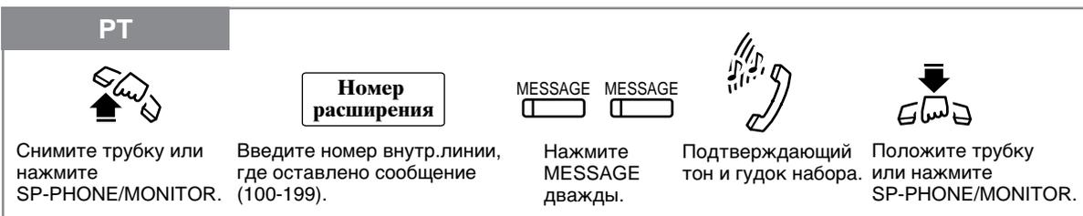
Снимите трубку или нажмите SP-PHONE/MONITOR.
