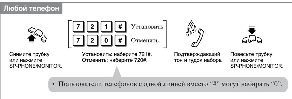
Снимите трубку или нажмите SP-PHONE/MONITOR.
