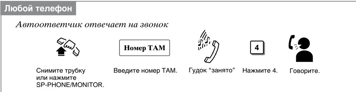
Снимите трубку или нажмите SP-PHONE/MONITOR.
