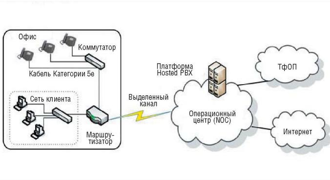
**Рисунок 1.** Услуга виртуальной АТС (Hosted PBX) позволяет использовать возможности IP-телефонии, не приобретая дополнительного оборудования. Необходимая для этого программно-аппаратная платформа находится у оператора.
